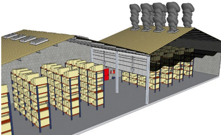
* Sectorització de magatzem amb cortina automàtica.
